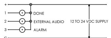
**DETAIL OF TYPICAL RELAY OUTPUT**
